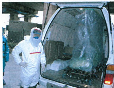
緊急搬送車の養生
